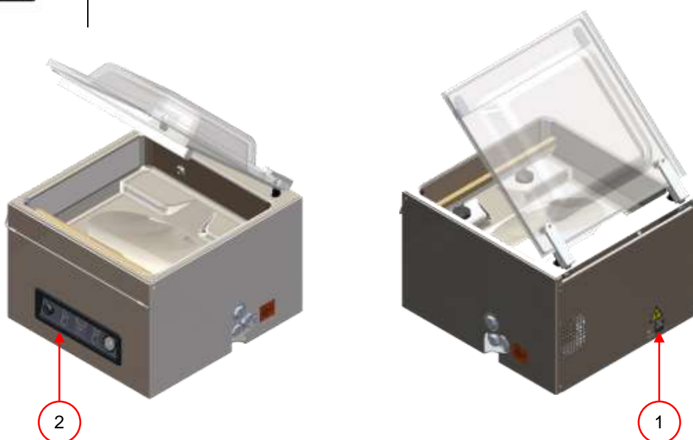
Figuur 4: Overzicht van de elektrische installatie
